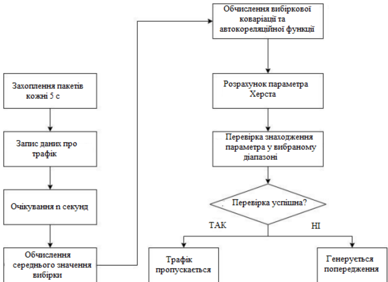
Рисунок 2.3 – Порядок дій роботи методу детектування аномалій на базі розрахунку показника Херста
