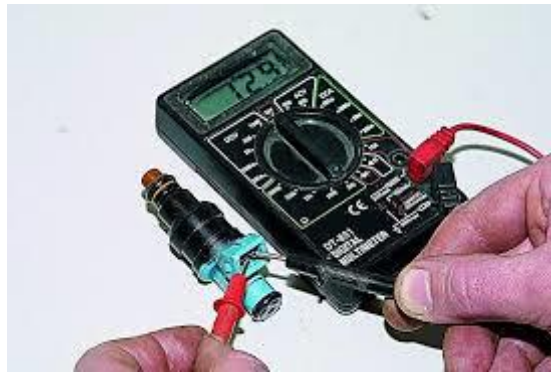
Рис.8 –Перевірка електричного опору форсунок тестером.
