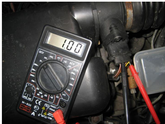
Рисунок 6 – Підключення тестера до ДМВП на автомобілі.
