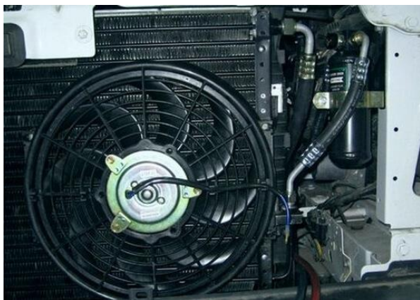
Рис.4 – Конденсатор з вентилятором
