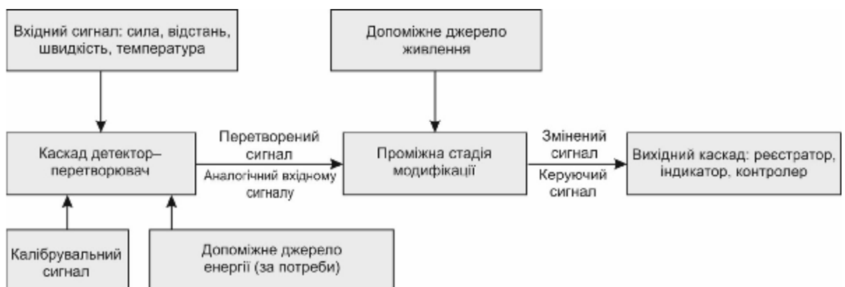
Рисунок 1.1 – Елементи узагальненої системи вимірювань
