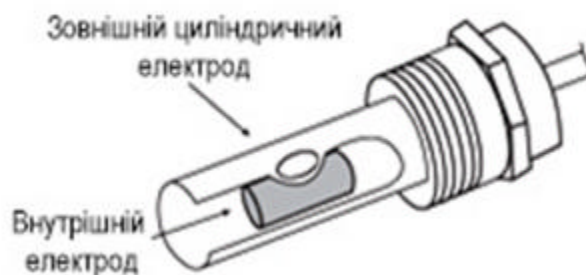
Рисунок 4.4 - Конструкція двохелектродного кондуктометричного давача
