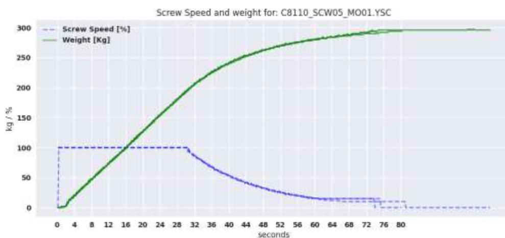
Рисунок 4.5 - Випробування Р-Control для гвинта 5
