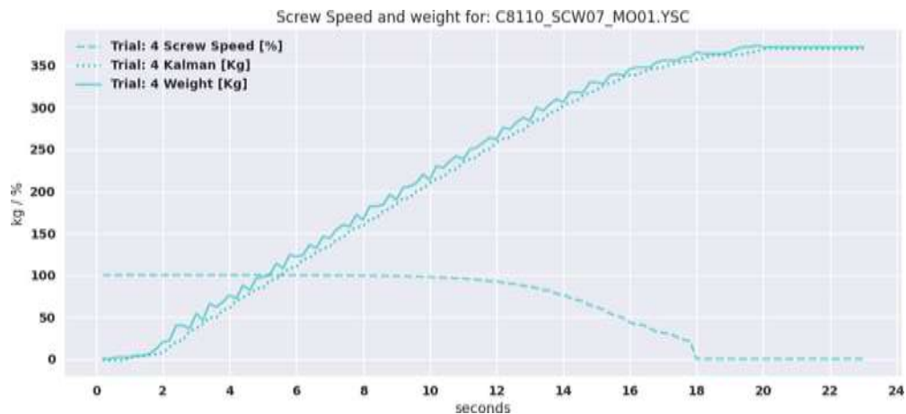
Рисунок 5.5 - Повністю зібране рішення. Фільтр Калмана перевірено на гвинті 7
