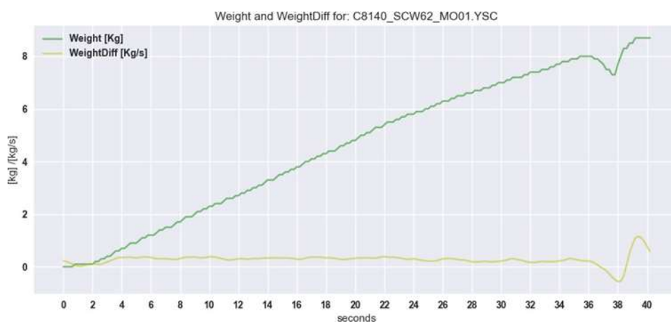
Рисунок 4.13 - Відфільтрована похідна ваги для гвинта 62
