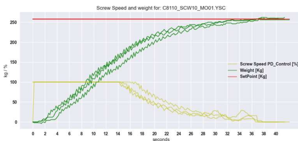
Рисунок 4.17 - Multi State-Control для гвинта 10
