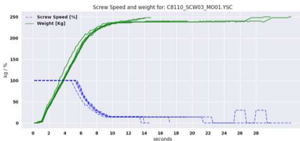
Рисунок 4.3 - Випробування Р-Control для гвинта 3
