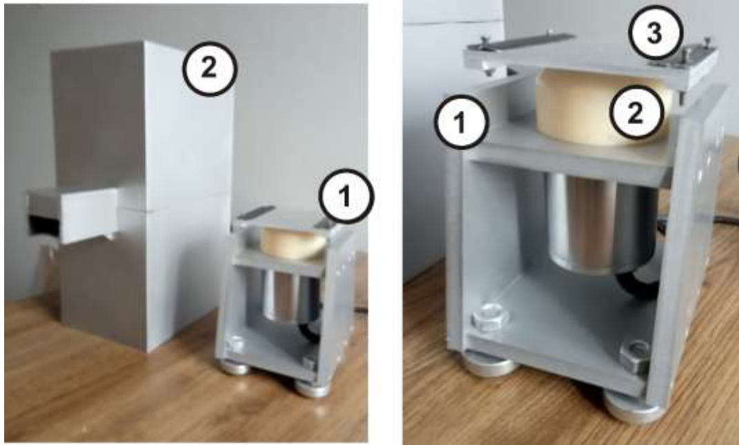
Рис. 3.8. Вібростенд та камера для дослідження впливу вібрацій: 1- вібростенд, 2- камера для досліджень
