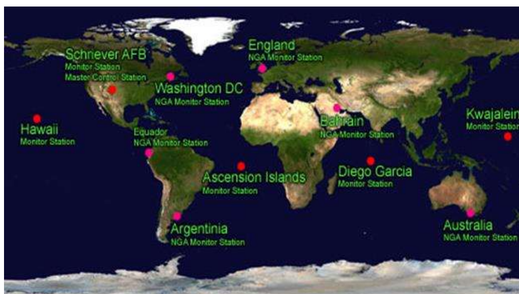
Рисунок 3.1 – Схема розташування станцій сегмента управління GPS.
