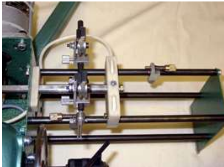
Рисунок 1.3 - Розкладальник намотувального верстата.
