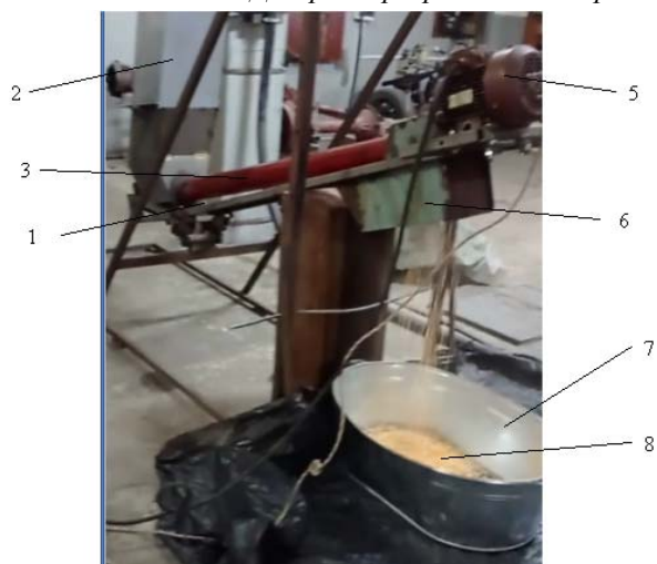
Рисунок 4 - Фрагмент процесу транспортування та змішування сипких матеріалів гвинтовим конвеєром-змішувачем
