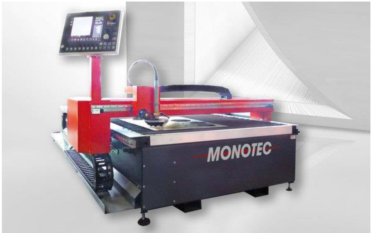
Рис. 2.2 – Загальний вигляд портальної автоматичної машини MONOTEC Type-1530
