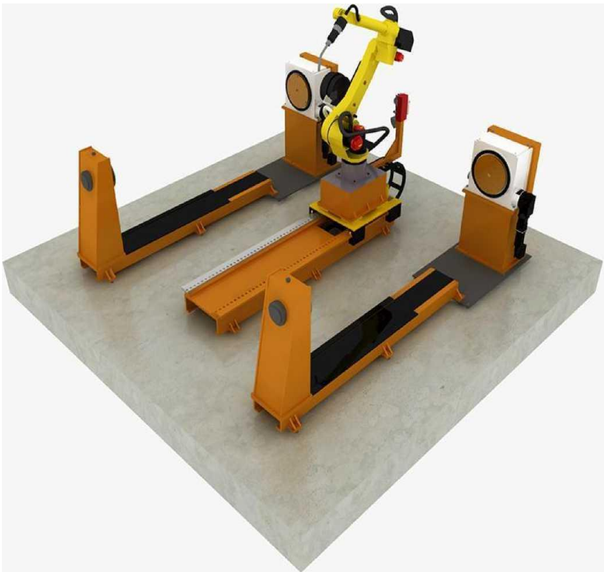
Рисунок 3.12 – Схематичне зображення установки для складання та роботизованого зварювання аргоним зварюванням металевих дверей.
