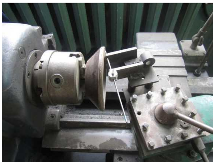
Рисунок 4.4 - Пристрій для заточування електродів
