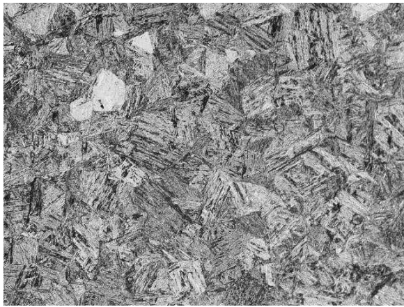
Рис. 2.2. КЗ ЗТВ змодельована на термоциклічному симуляторі
