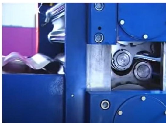
Рис. 3.12 – Формування гофри вертикальної стінки [18]
