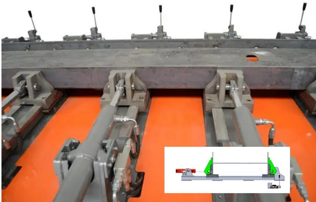
Рис. 3.11 – Стенд-установка для складання гофрбалки
