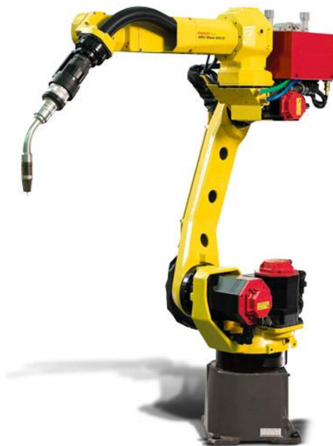
Рис. 3.2 – Робот ARC Mate 100iC/12 [14]
