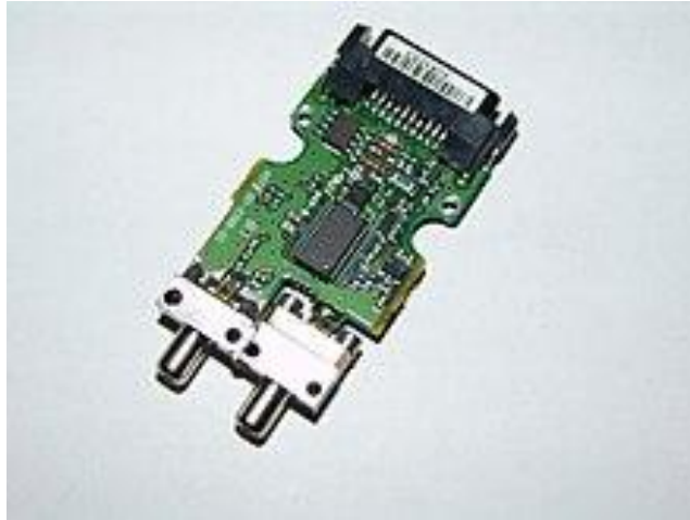
Рис. 1.3. Модуль GBIC — це оптичний і електричний приймач, пристрій, що поєднує передавач і приймач в одному корпусі. Електричний роз'єм знаходиться вгорі праворуч, а оптичні роз'єми — унизу ліворуч.
