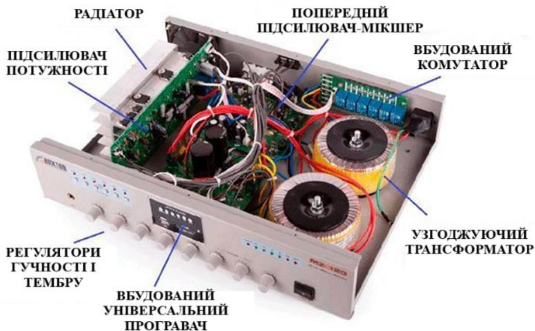
Рис. 1.6. Конструктивне виконання трансляційного підсилювача на прикладі моделі ROXTON MZ-240
