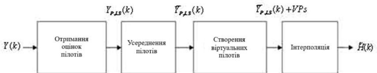
Рис. 3.6. Укрупнена схема блоку оцінки каналу
