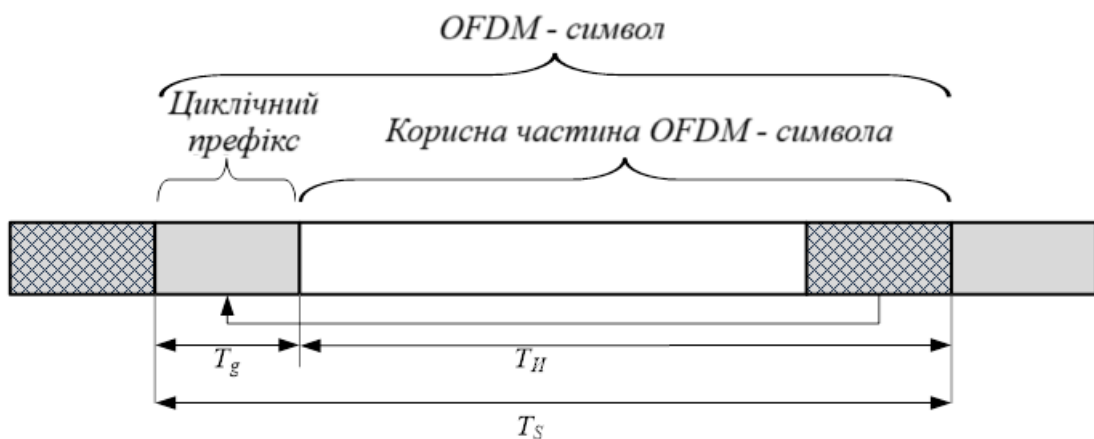
Рис. 1.7. Часова структура OFDM-символу LTE
