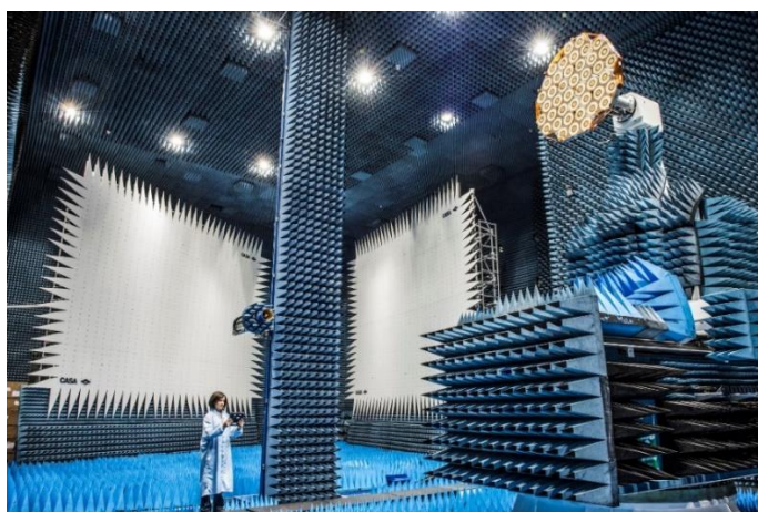
Рис.4.1. Анехоічна камера HERTZ для тестування супутникових антен у лабораторних умовах
