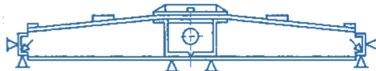
Рис. 2.17 - Схему базування елементів рами при складанні шкворневого вузла
