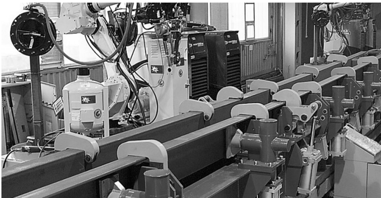
Рис. 2.15 Розташування зетів при складанні в кондукторі [21 ]
