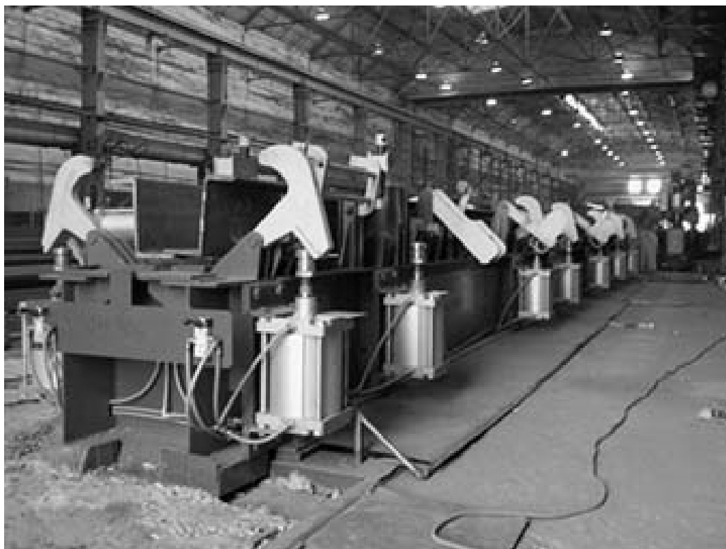
Рис. 4.1 - Кондуктор для складання та зварювання хребтової балки [23]
