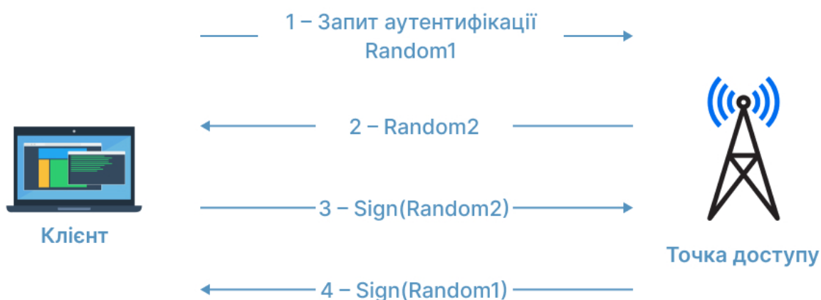
Рис. 2.5. – Схема взаємної аутентифікації на каналному рівні
