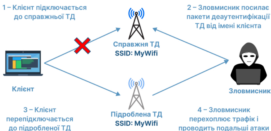
Рис. 1.19. – Принцип імітації Rogue Access Point атаки
