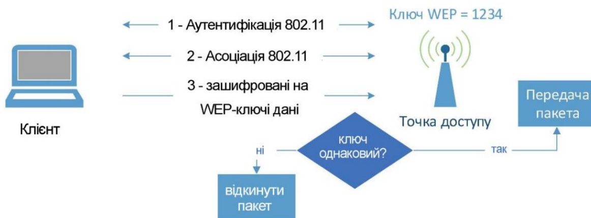
Рис. 1.10 – Процес відкритої аутентифікації за використання протоколу WEP
