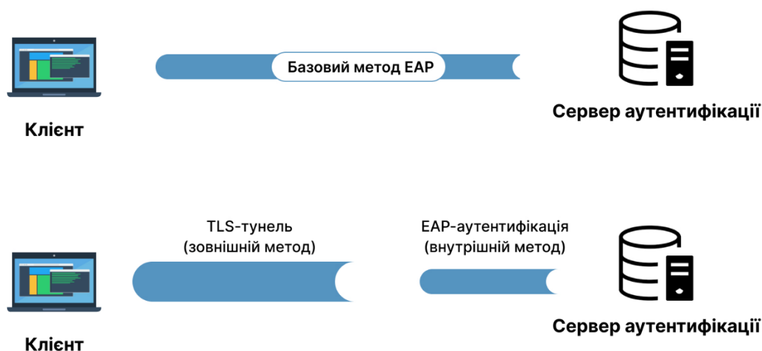
Рис. 1.15. – Порівняння методів аутентифікації з використанням тунелювання та базового підходу
