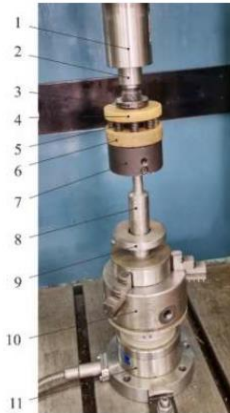
Рисунок 2.9 – Вимірювання крутного моменту:
