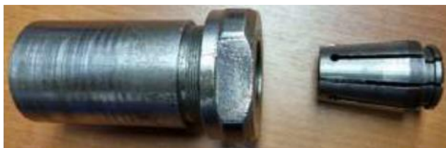
Рисунок 3.10 – Модель цангового патрона з комплектом цанг
