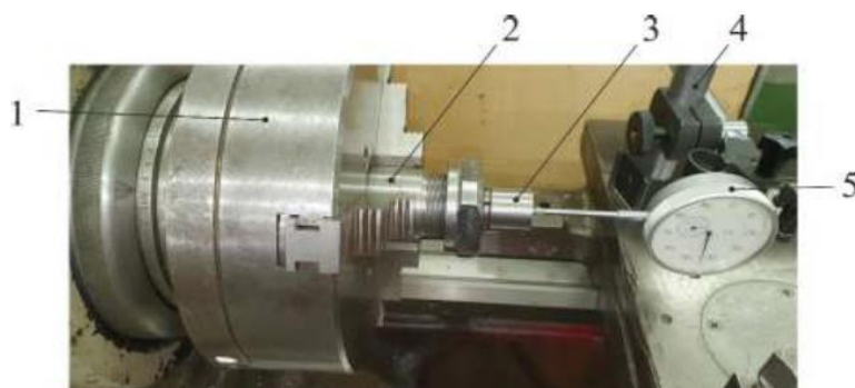
Рисунок 3.12 – Вимірювання точності закріплення деталі в цанговому патроні в осьовому напрямку: 1 – токарний патрон; 2 – модель патрона; 3 – деталь; 4 – штатив; 5 – індикатор
