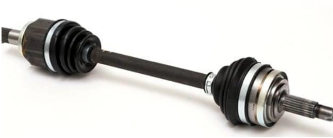
Рисунок 13 – Вал з шарнірами рівних кутових швидкостей.
