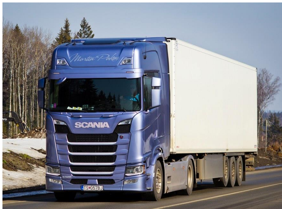
Рисунок 18 – Автомобіль-тягач класу N3 -Scania S500 з напівпричіпом підкатегорії O4
