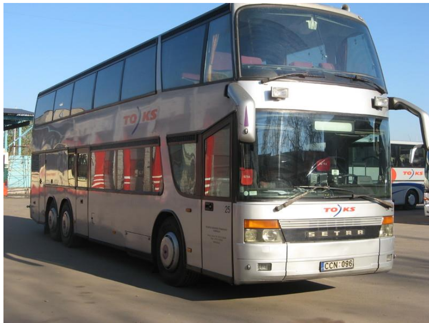
Рисунок 17 – Автомобіль підкатегорії M3 - Автобус SETRA S 328 DT
