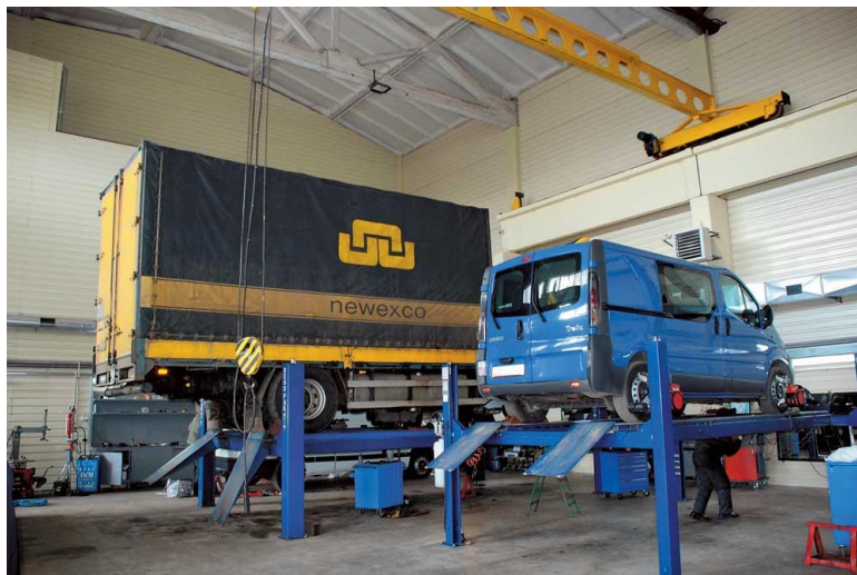
Рисунок 5 - Електромеханічний підйомник чотири стоячковий Підвісні і пересувні крани (рис.6) застосовують для знімання, встановлення і транспортування агрегатів автомобіля на невеликі відстані.
