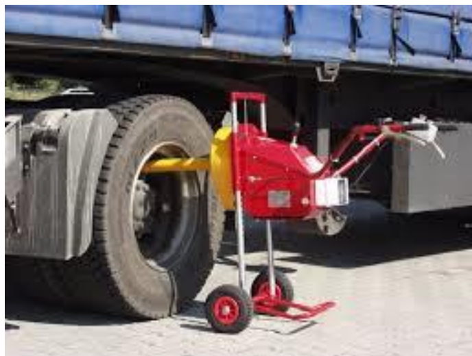
Рисунок 19 – Електромеханічний пересувний реверсивний інерційно-ударний гайковерт
