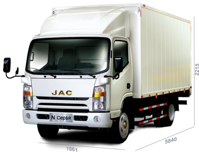
Рисунок 16 – Автомобіль класу N1 - JAC N56, 3,45 т.
