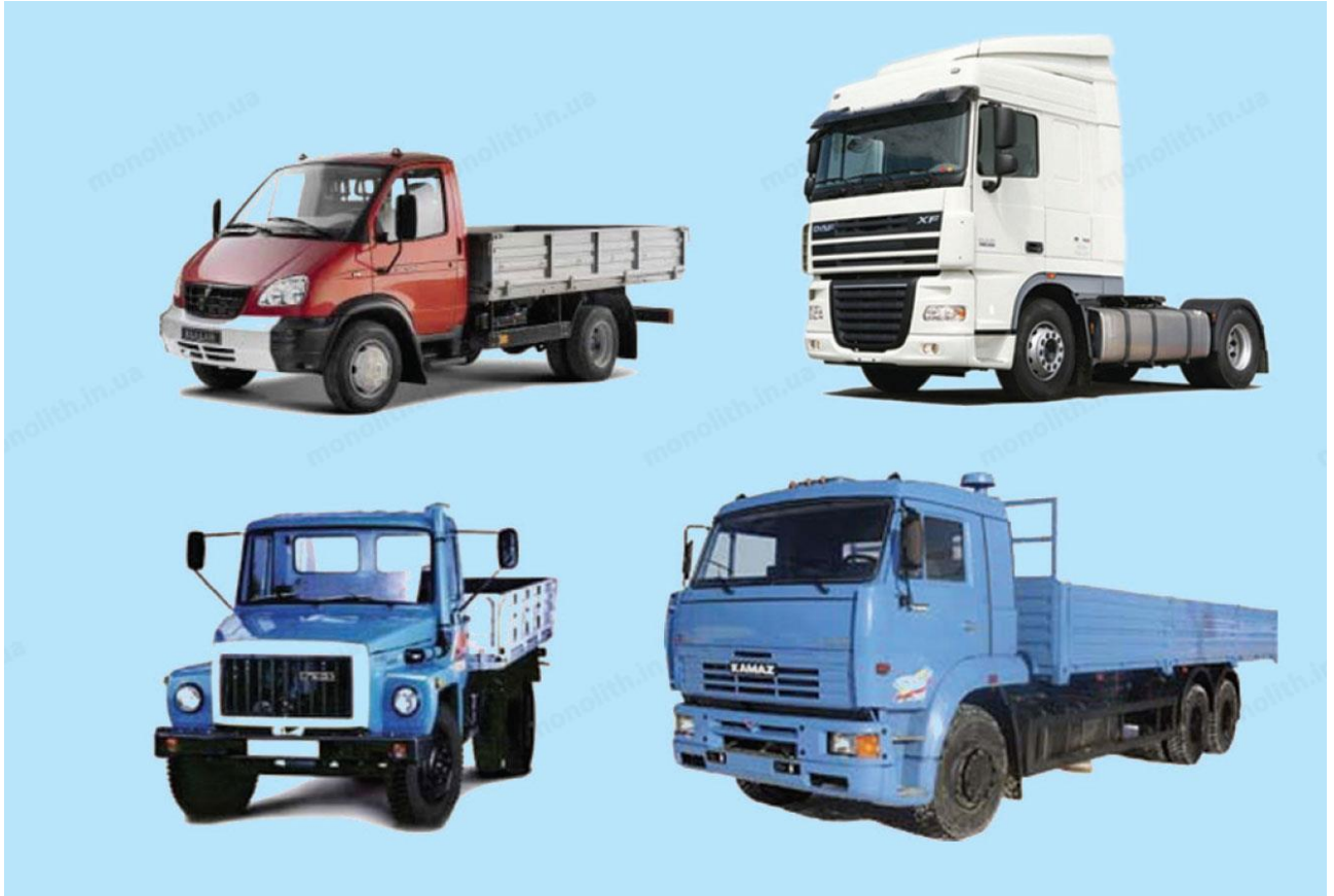
Рисунок 4 – Капотні і безкапотні конструкції кабін автомобілів
