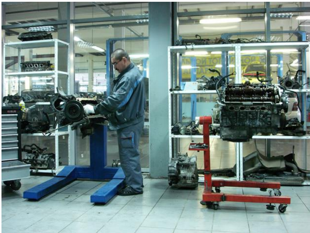
Рисунок 17 – Стенди для розбирання і збирання двигуна в моторній дільниці.
