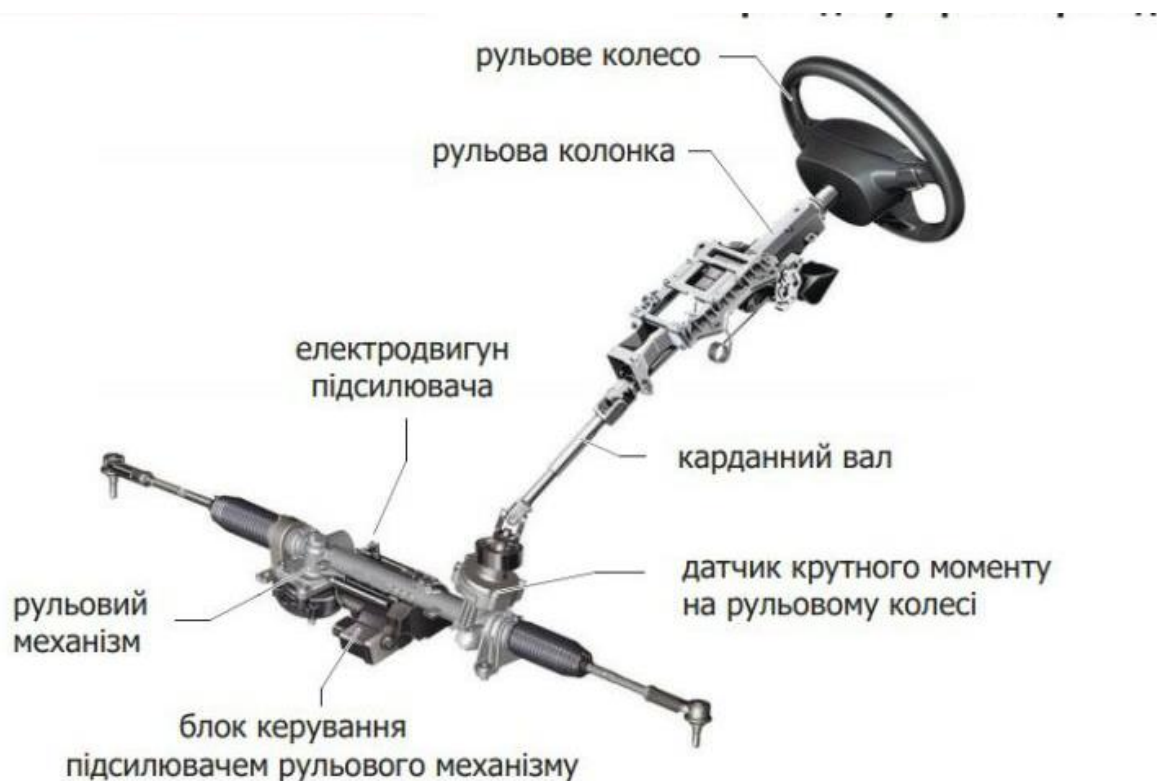
Рисунок 18 - Рульове керування з електропідсилювачем.
