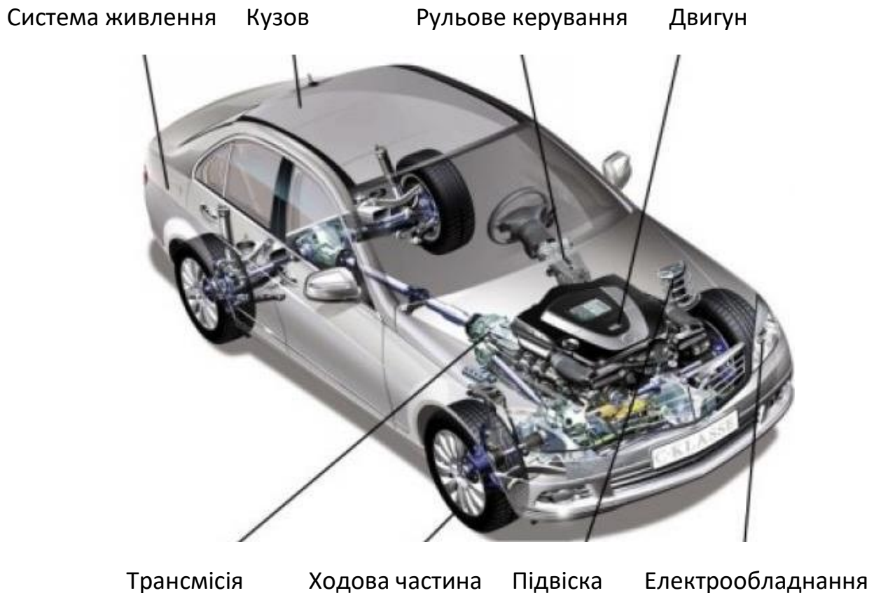
Рисунок 1 – Основні частини легкового автомобіля.
