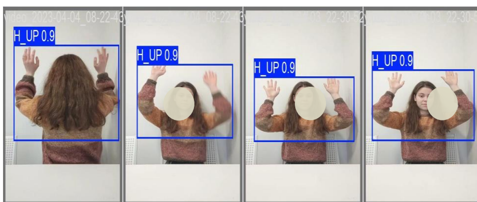
Рис.3.13. Результати виявлення небезпечних ситуацій КСВ з використанням моделі YOLOv8s
