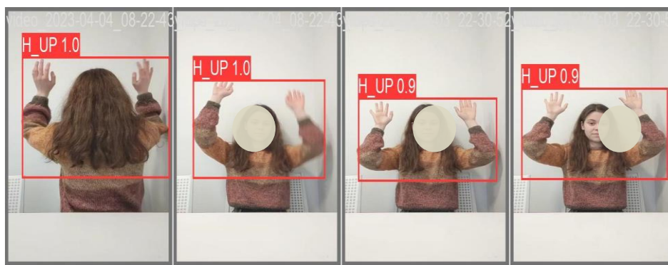
Рис.3.14. Результати виявлення небезпечних ситуацій КСВ з використанням моделі YOLOv10s
