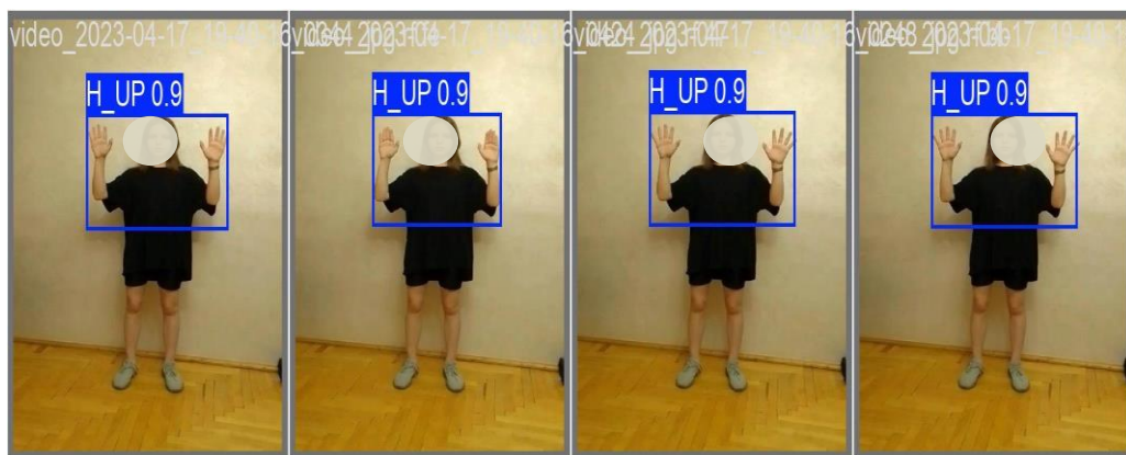
Рис.3.15. Результати виявлення небезпечних ситуацій КСВ з використанням моделі YOLOv11s
