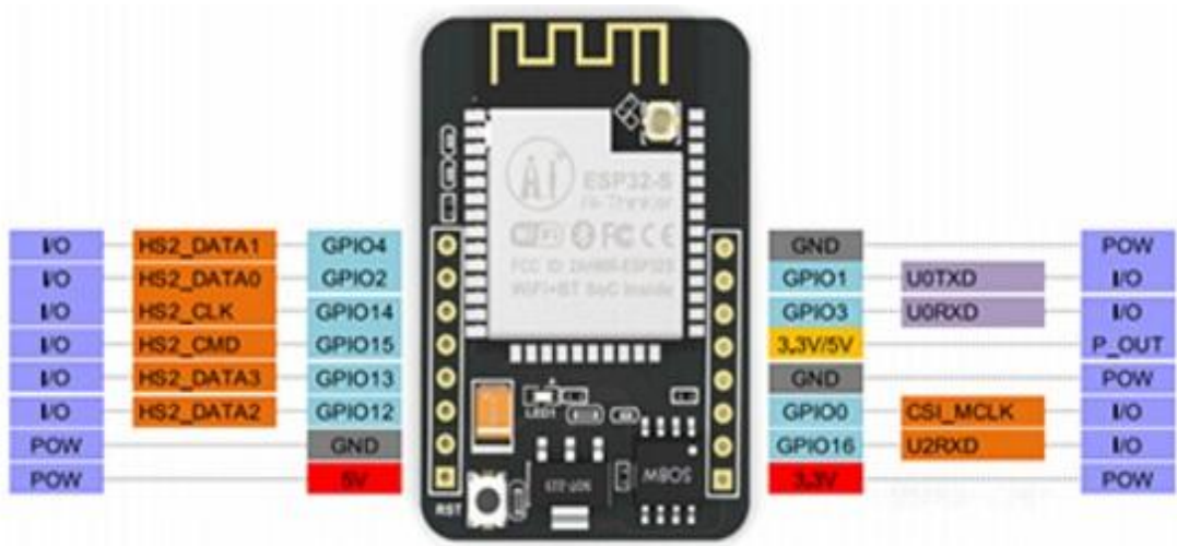
Рис. 2.11. Виводи ESP32-CAM
