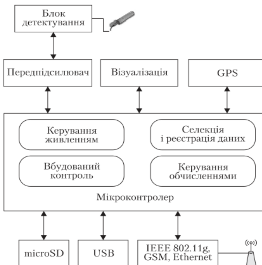
Рис. 1.1. Структурна схема аналізатора джерел радіації [8]
