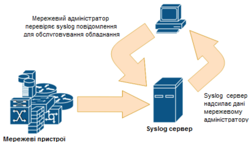
Рис. 3.1. Збір та обробка системних журналів syslog
