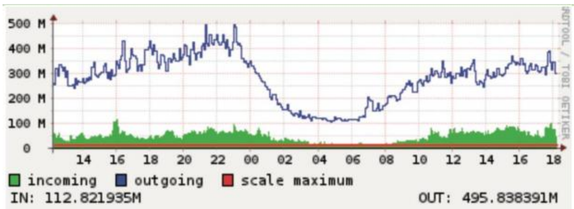
Рис. 1.2. Графік утилізації пропускної спроможності, побудований з допомогою Cacti
