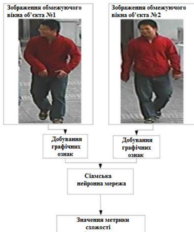
Рис. 2.8. Принцип роботи моделі сіамської нейронної мережі
