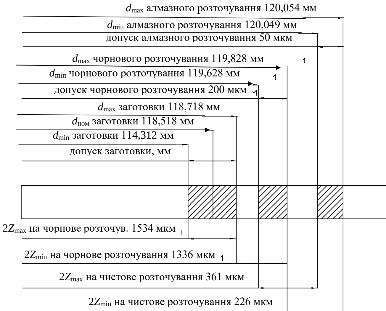
Рис. 3.1. Графічний розрахунок припусків
