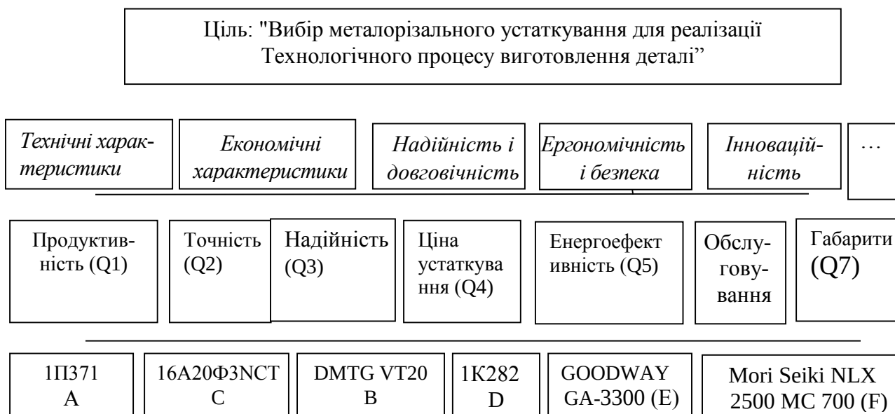
Рисунок 2.9 - Фрагмент ієрархії задачі вибору раціонального устаткування для реалізації ТП виготовлення корпусу ЖВМ 22.122.22
