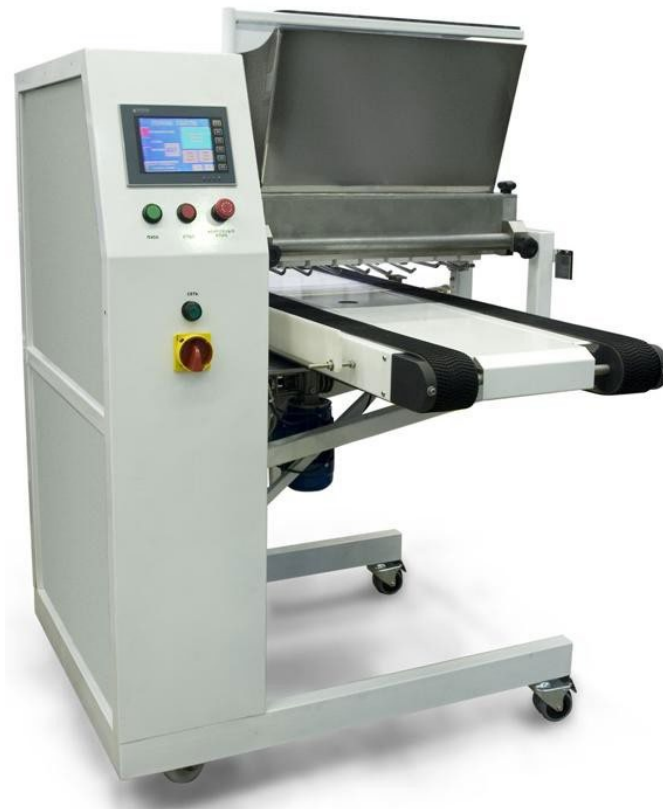
Рис. 1.6. Тістовідсадкова машина Питпак ОП-3
