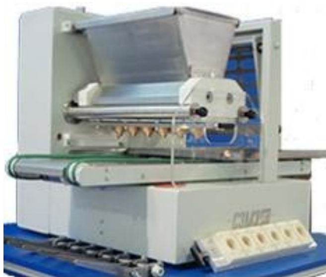
Рис. 1.5. Машина відсаджувальна Колібри ОДММ-1
