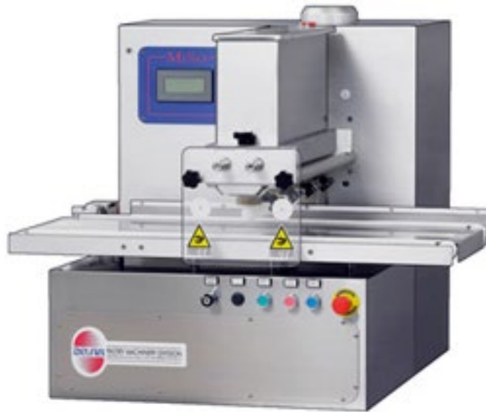
Рис. 1.1. Тістовідсаджувальна машина Delfin MINO 400.
