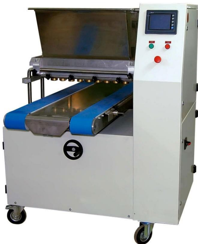
Рис. 1.7. Машина тістовідсаджувальна ТОМ 200
