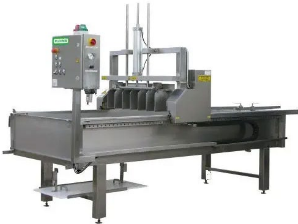
Рис 1.2. Прес для пресування сиру PRP-AP (Plevnik)
