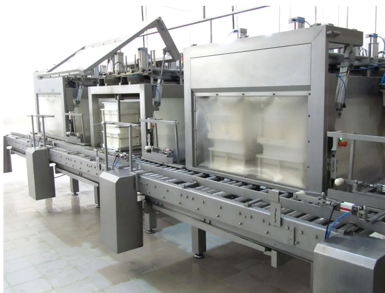
Рис. 1.6. Вертикальний прес для сиру Prensamatic (Fibosa)
