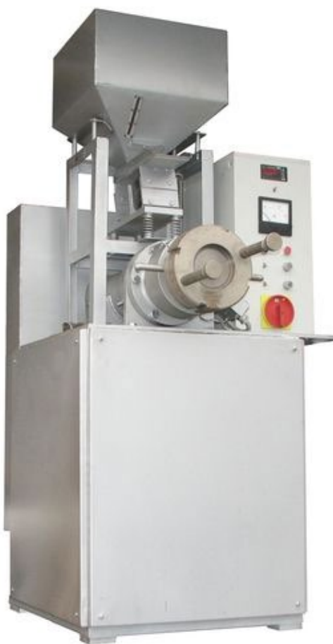
Рис. 1.11. Екструдер для кукурудзяних паличок марки ЕКП-100
