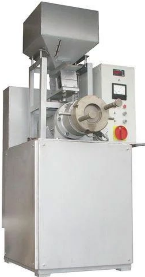
Рис. 1.7. Екструдер для виробництва кукурудзяних паличок ЕКП-100, продуктивністю 100 кг/год.
