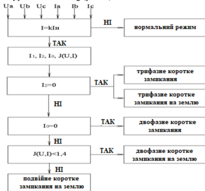
Рисунок 2. Блок-схема визначення виду міжфазних пошкоджень досліджуваної мережі
