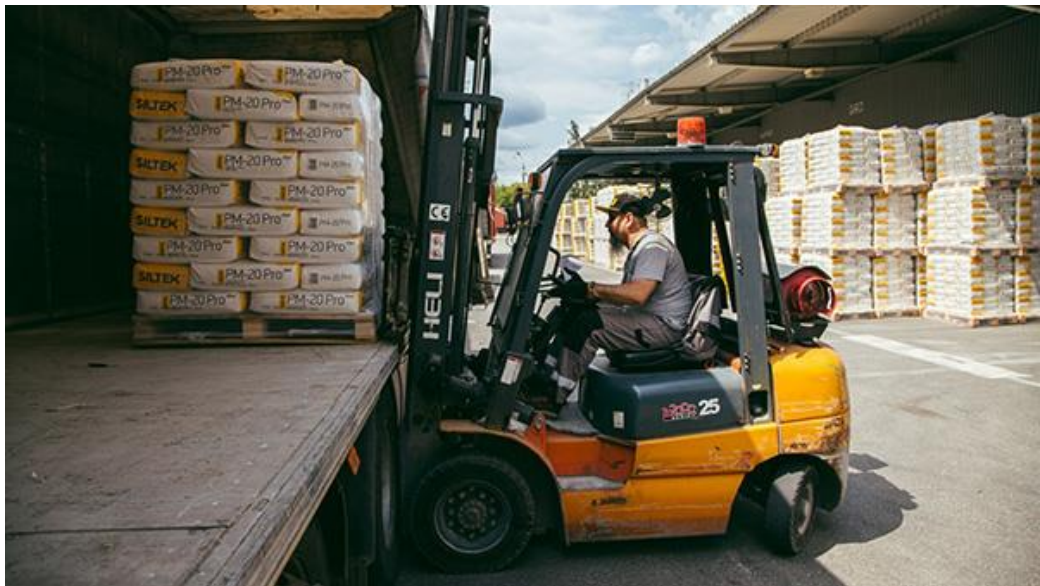
Рисунок 2.11 – Вилковий навантажувач «HELI» серії G CPQ (Y) D25
