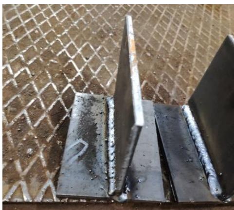
Рисунок 3.8 – Зразки виконані на прямій та зворотній полярності
