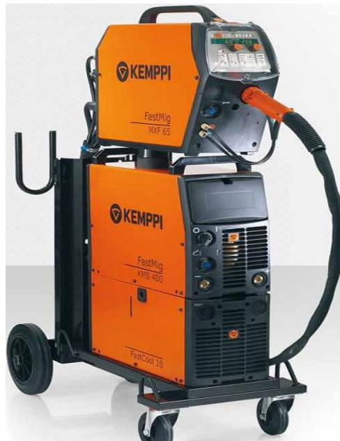
Рисунок 3.6 – Загальний вигляд джерела живлення Kempri FastMIG M420+MXf65
