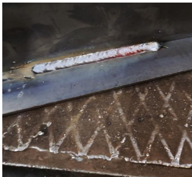
Рисунок 3.7 – Загальний вигляд пробного зварювання пластин
