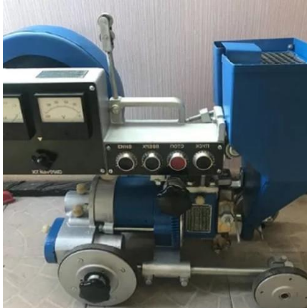
Рисунок 3.5 – Загальний вигляд зварювального трактора АДФ 1002
