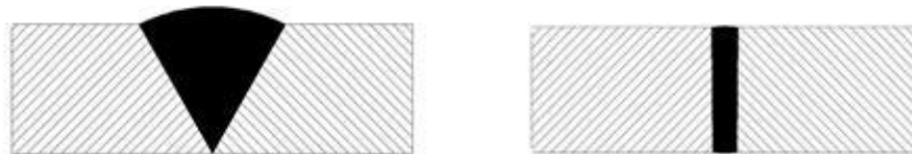
Рисунок 1.6 – Зварювання по вузькому та щілинному зазору
