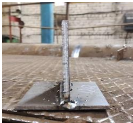
Рисунок 3.8 – Зразки виконані на прямій та зворотній полярності
