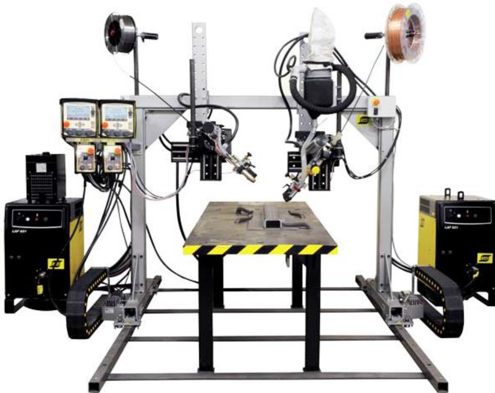
Рисунок 4.4 – Зварювальна колона фірми ESAB MECHTRAC 3000
