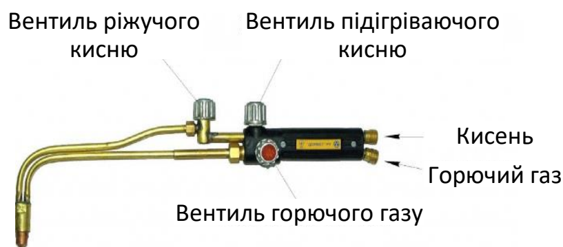
Рисунок 1.9 – Конструкція газового різак
