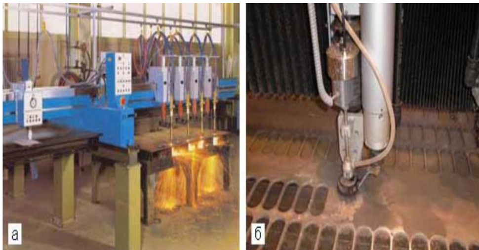
Рисунок 1.3 – Установки для термічних способів різання: а – газова; б – плазмова
