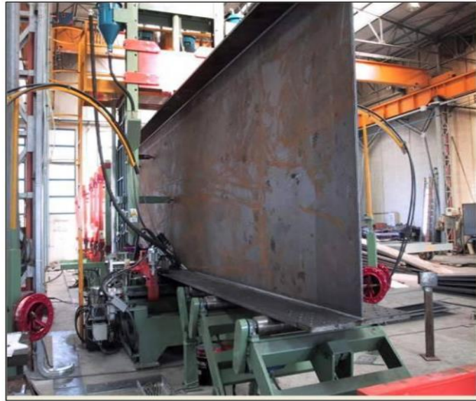
Рисунок 4.9 – Технологічний процес зварювання балки
