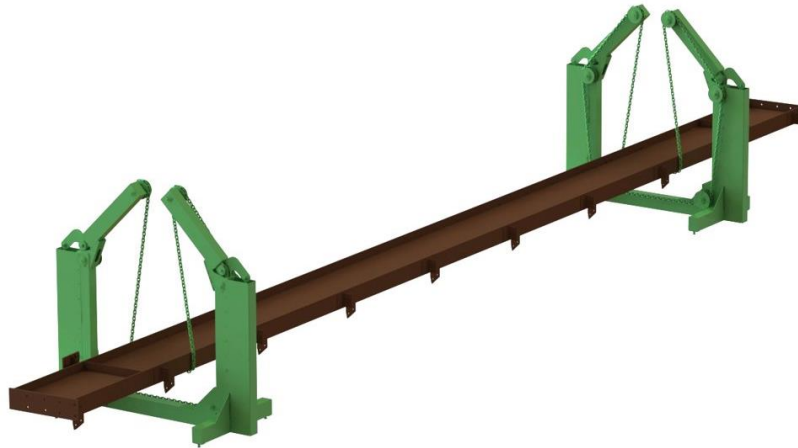
Рисунок 4.10 – Кантувач збірно-зварювальний КЦР-3.
