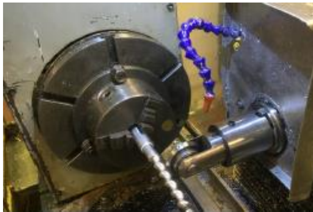
Рисунок 1.13 – Обкатування роликом програмним способом
