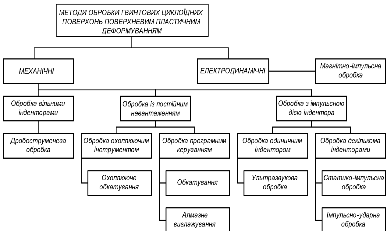
Рисунок 1.15 – Класифікація методів обробки поверхневим пластичним деформуванням
