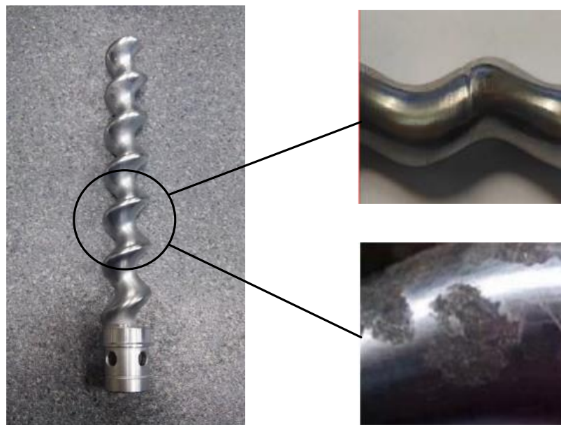
Рисунок 1.3 – Ротор дозатора із руйнуваннями внаслідок абразивного зносу і точкової корозії
