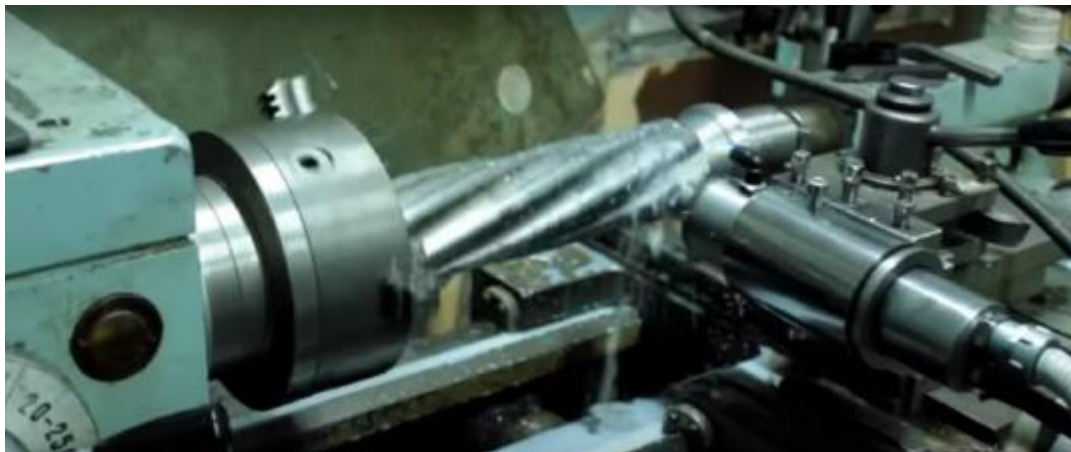
Рисунок 1.9 – Ультразвукова обробка ротора на токарному верстаті
