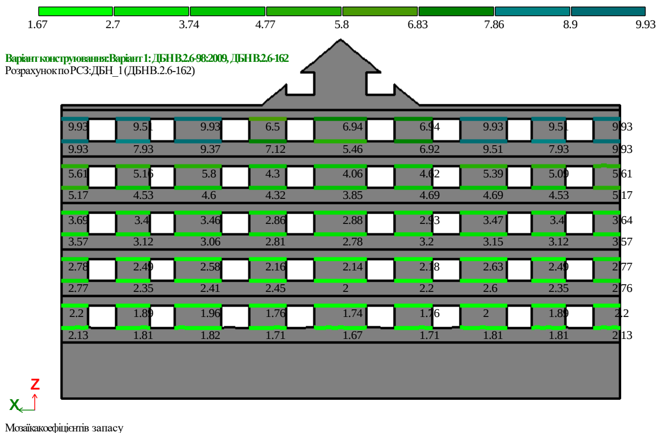
Рисунок 2.25 – Коефіцієнти запасу міцності простінків цегляної стіни
