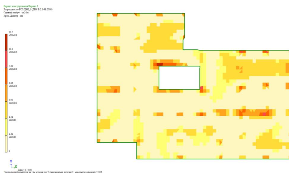
Рисунок 2.17 – Мозаїка армування типової плити перекриття в напрямку Y від розрахункових сполучень зусиль
