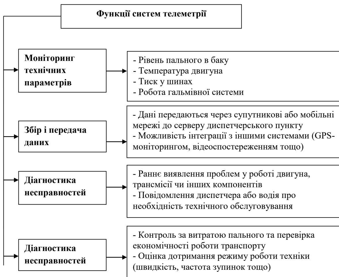
Рисунок 3.1. Функціональне навантаження системи телеметрії.
