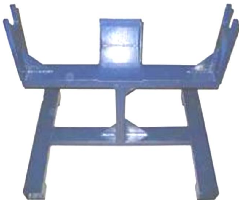
Рисунок 3.1 – Загальний вигляд стунду для ремонту головної передачі
