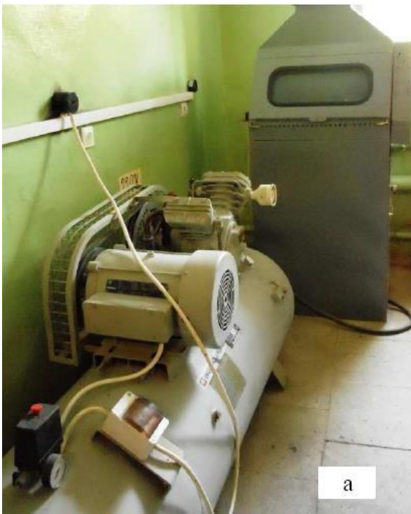
Рисунок 3.4 - Устаткування для піскострумної обробки поверхонь вала: а - компресор з піскострумною камерою; б - робочі ролики і сопло піскострумного апарату
