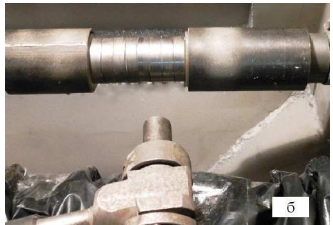
Рисунок 3.4 - Устаткування для піскострумної обробки поверхонь вала: а - компресор з піскострумною камерою; б - робочі ролики і сопло піскострумного апарату
