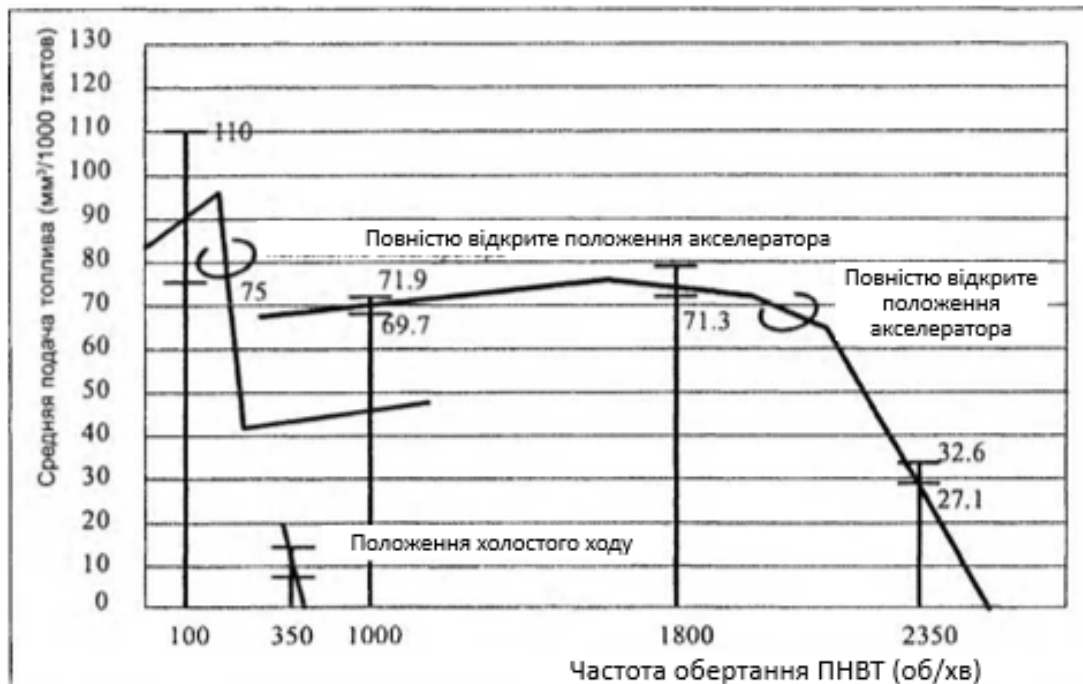
Рисунок 2.4 – Схема регулювання ПНВТ. Дизельні двигуни CYQD32T
