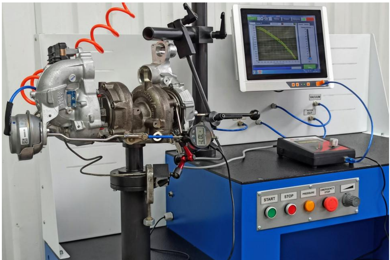
Рисунок 3.2 – Стенд калібрування турбокомпресора «ГЕОМЕТ-2000»
