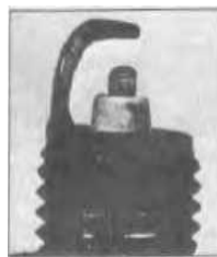
Зношування. Симптоми. Округлення електродів з незначним накопиченням
