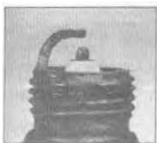
Перегрів. Пористий, білий ізолятор. ерозія електродів і відсутність
