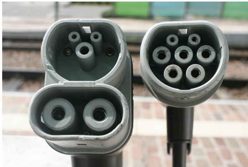
Рисунок 2.6 – Конструкція стандарту зарядки Type 2
