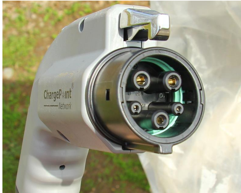
Рисунок 2.5 – Конструкція стандарту зарядки Type 1 (SAE J1772)
