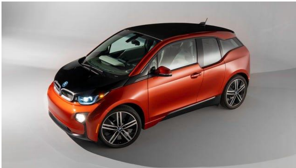
Рисунок 2.7 – Приклад послідовного гібриду – BMW i3 REx
