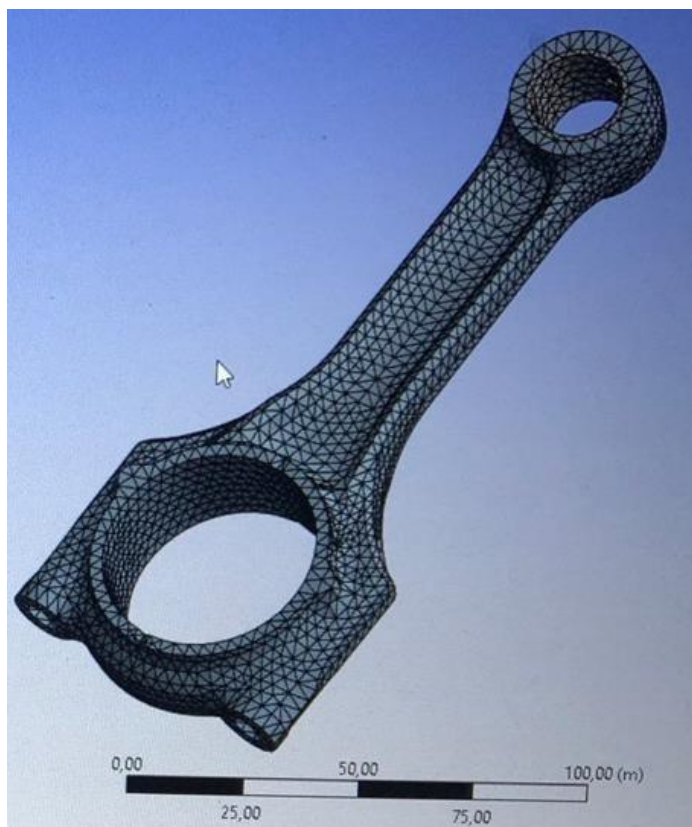
Рисунок 3.13 – Цифрова модель шатуна з сіткою
