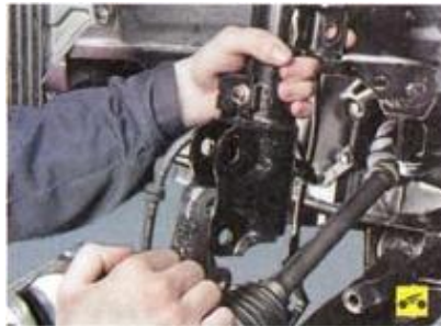
Рисунок 2.12 Від'єднання амортизаторної стійки від поворотного кулака.
