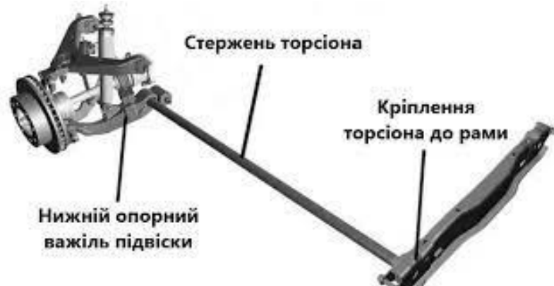
Рисунок 1.5 Конструкція торсійної підвіски незалежного типу.
