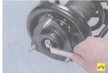
Рисунок 2.14 Відкручення гайка штока амортизатора.
