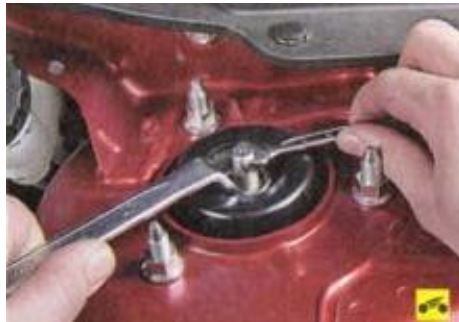
Рисунок 2.9 Послаблення затягнення гайки верхнього кріплення амортизаторної стійки
