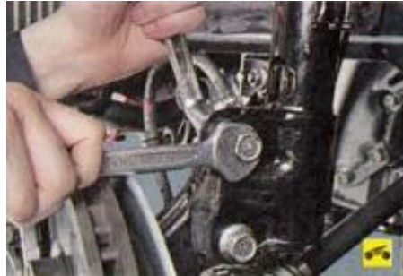
Рисунок 2.11 Відкручення гайки кріплення телескопічної стійки до поворотного кулака.
