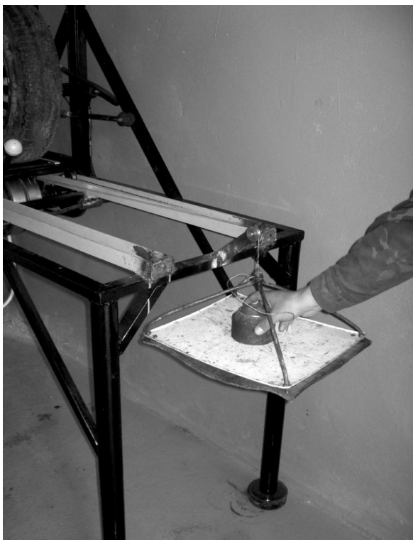
Рисунок 3.3 – Механізм навантаження платформи
