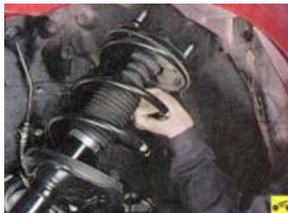
Рисунок 2.13 Зняття амортизаторної стійки з автомобіля.
