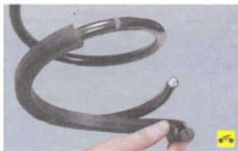
Рисунок 2.15 Нижня гумова прокладка пружини.
