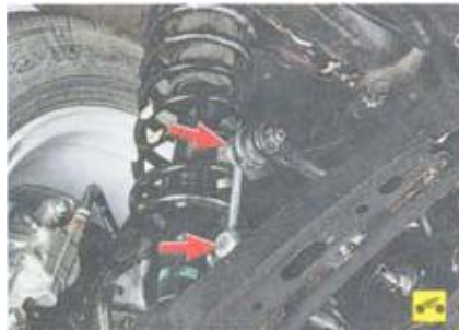
Рисунок 2.5 Послідовність перевірки кульових шарнірів стійки стабілізатора.
