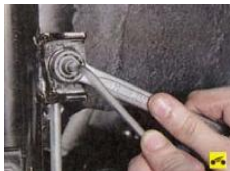
Рисунок 2.10 Від'єднання верхнього шарніра стійки стабілізатора.
