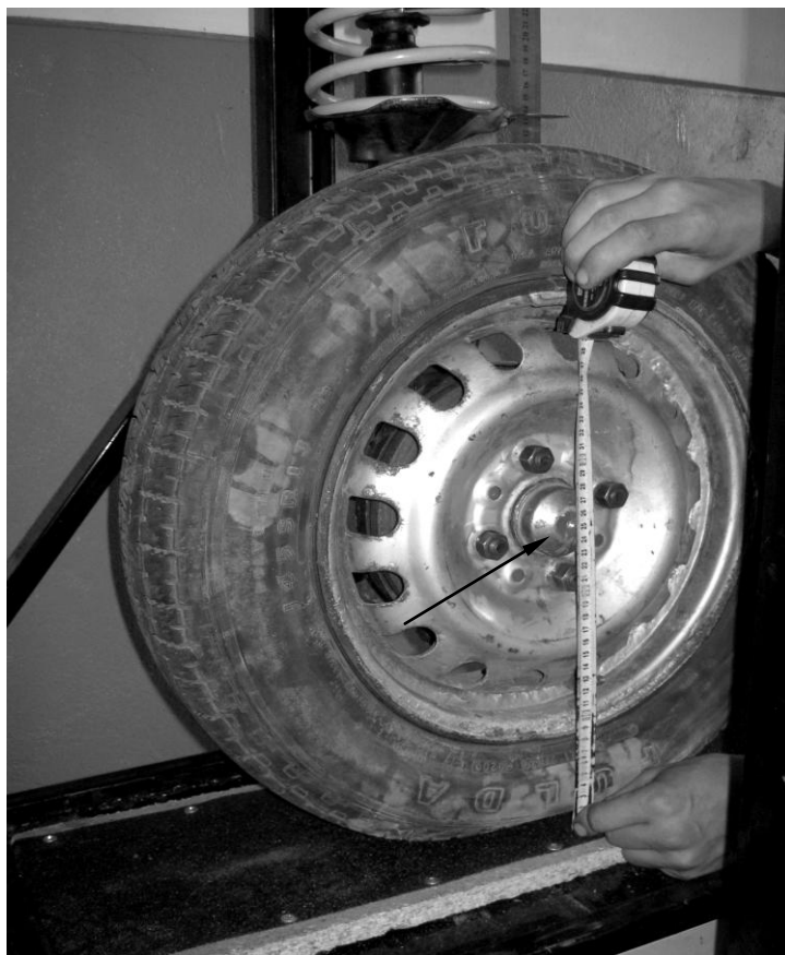
Рисунок 3.4 – Послідовність вимірювання величини статичного радіуса колеса автомобіля.
